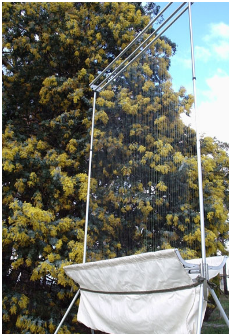
FIGURE 3 – Harptrap . Système de capture par fils de nylon tendus verticalement (Austbat Harptrap©).
